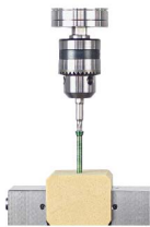
金属接骨螺钉自攻测试
