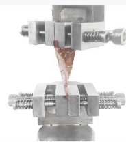
柔性电路板扭转测试
